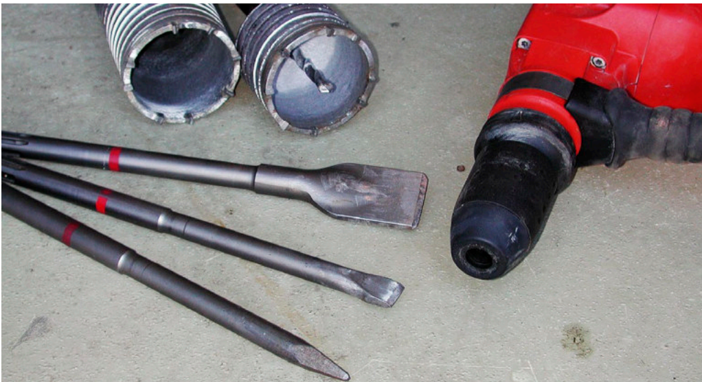
Bohrhammer mit verschiedenen Meißeln und Bohrkronen
